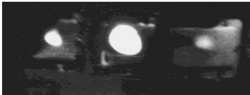
Рис. 7. Полученные изображения сечения пучка e^- при E \approx 50 МэВ с использованием люминесцентного и переходного излучений (см. пояснения в тексте).
