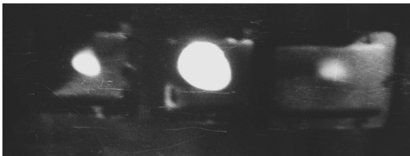
Рис. 2. Полученные изображения пучка электронов при E^- \approx 50 МэВ с использованием (справа налево): нелинейного люминофора; ZnS; чистой Al-фольги (свет от переходного излучения)
